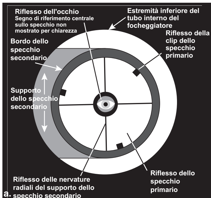
Figura 8. Collimazione dell'ottica. (a) Se gli specchi sono allineati correttamente, l'immagine attraverso il tubo interno del focheggiatore dovrebbe assomigliare a quella illustrata. (b) Con il tappo di collimazione applicato, se l'ottica non è allineata, l'immagine potrebbe assomigliare a quella illustrata. (c) In questo caso lo specchio secondario è centrato sotto il focheggiatore, ma deve essere regolato (inclinato) in modo che l'intero specchio primario sia visibile. (d) Lo specchio secondario è allineato correttamente, ma lo specchio primario ha ancora bisogno di regolazione. Quando lo specchio primario è allineato correttamente, il punto risulta centrato, come in (e).
