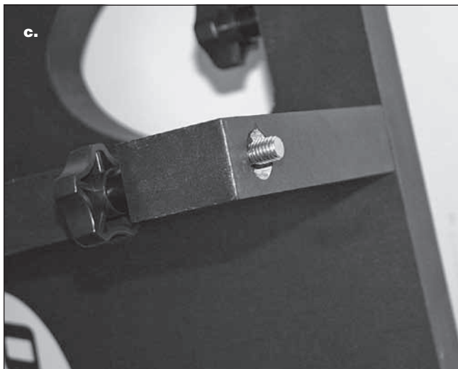
Figura 9. a) Coloque una arandela de goma en el extremo roscado del perno de conexión y empújela todo lo que pueda con los dedos. b) A continuación, utilice el tubo de inserción incluido para empujar la arandela a través de la rosca del agujero roscado en la madera. c) La arandela empotrada mantendrá cautivo el perno en el agujero.
