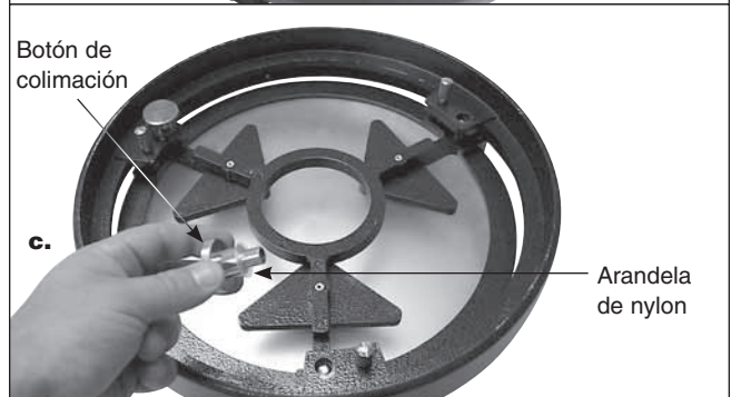
Figura 16. Se muestra para XX12g. a) Coloque los tres resortes en los ejes roscados expuestos de la celda del espejo. b) Baje el anillo del extremo posterior en la celda del espejo de manera que los ejes roscados pasen a través del anillo del extremo y el anillo del extremo descansa sobre los resortes. c) Enrosque los botones de colimación, con las arandelas de nylon acopladas, a través del anillo del extremo posterior y en los ejes roscados. Asegúrese de que los botones tienen por lo menos tres vueltas completas de engranaje en los ejes.
