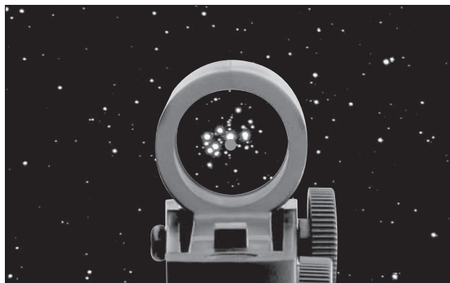
Figura 25. La EZ Finder II superpone un pequeño punto rojo en el cielo, mostrando exactamente donde está apuntando el telescopio.
