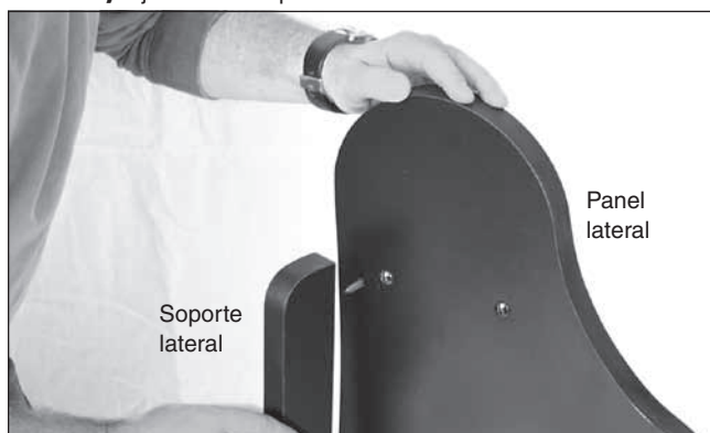
Figura 7. Acople un soporte lateral a la parte exterior de cada panel lateral con tres tornillos de madera de montaje de la base y la llave Allen de 4 mm.
