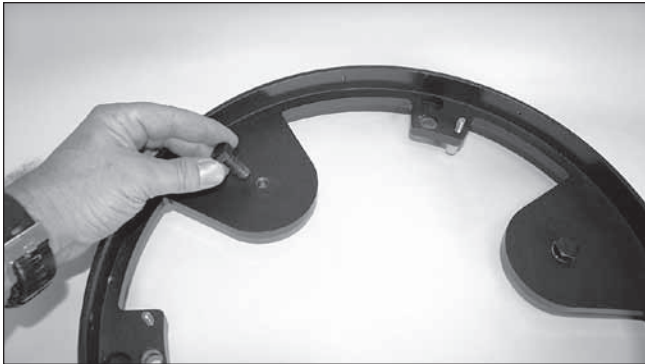
Figura 15. Enrosque los tres tornillos de montaje del contrapeso de cabeza hexagonal (solo XX14g y XX16g) en los orificios de las placas de soporte del contrapeso, según se muestra. Apriete con una llave inglesa ajustable o de 16 mm.
