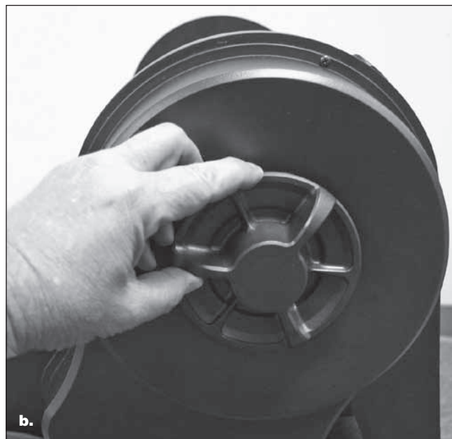
Figura 34. a) Las nuevas carcasas de motor/codificador de altura y acimut del dobsonianos XXg incorporan grandes botones de embrague manual para una tensión de movimiento ajustable. b) Gire el botón de embrague para ajustar la fricción de movimiento para girar el telescopio a mano.
