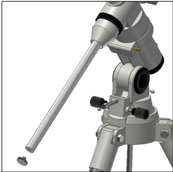
Figura 15. Extraiga el seguro de base para deslizar el contrapeso.
