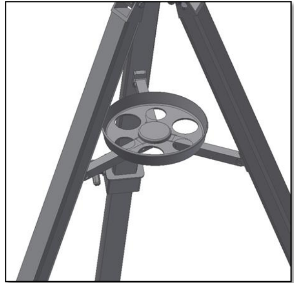
Figure 3. Mise en place de la tablette porte-accessoires
