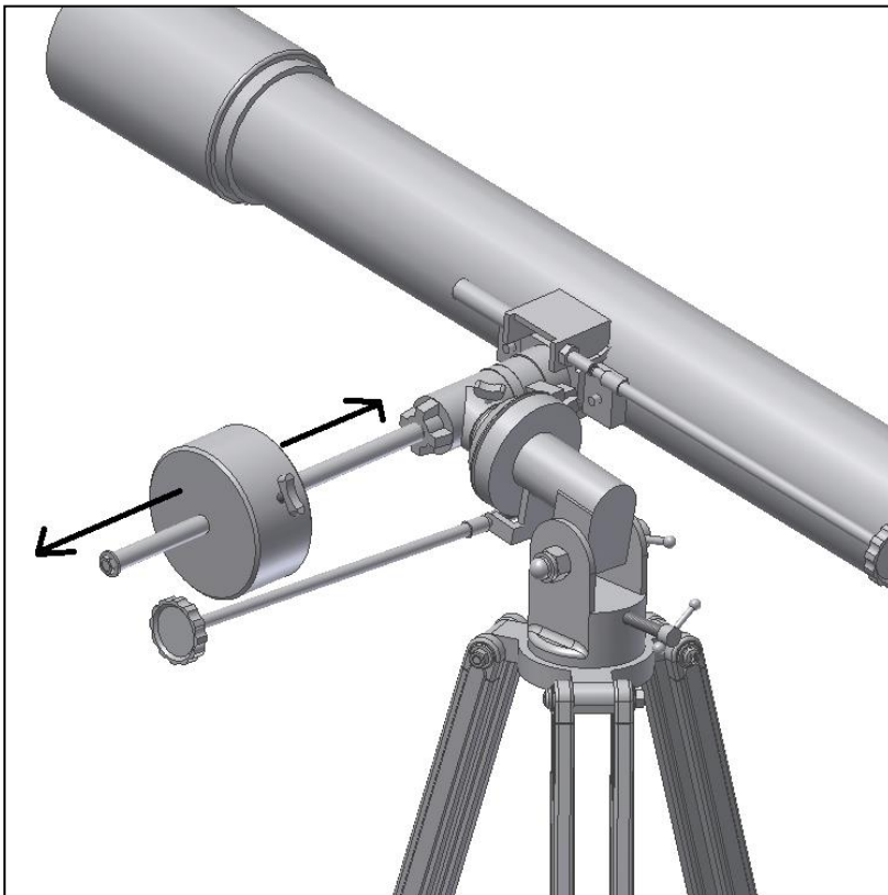
Figura 10. Equilibratura dell'asse di A.R. con il contrappeso.
