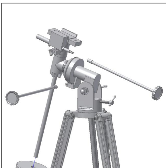
Figura 6. Montare le impugnature di declinazione e di ascensione retta.
