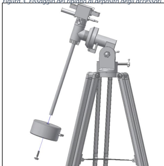
Figura 5. Inserire l'asta del contrappeso con il contrappeso.
