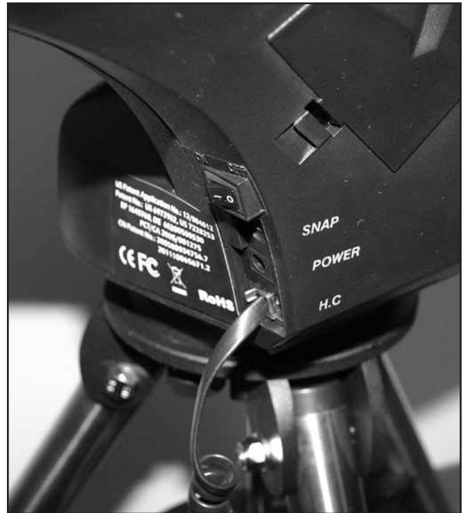
Figure 16 Les ports électroniques pour la télécommande et une batterie 12 V CC en option sont situés à la base du bras de la monture. Le port SNAP permet de contrôler un appareil photo reflex numérique lorsqu'il est utilisé avec un câble approprié.
