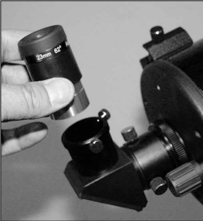
Figure 9. Insertion d'un oculaire dans le renvoi coudé d'un Maksutov-Cassegrain. Pour les modèles de télescopes réflecteurs, l'oculaire est installé directement dans le collier pour accessoire du porte-oculaire.
