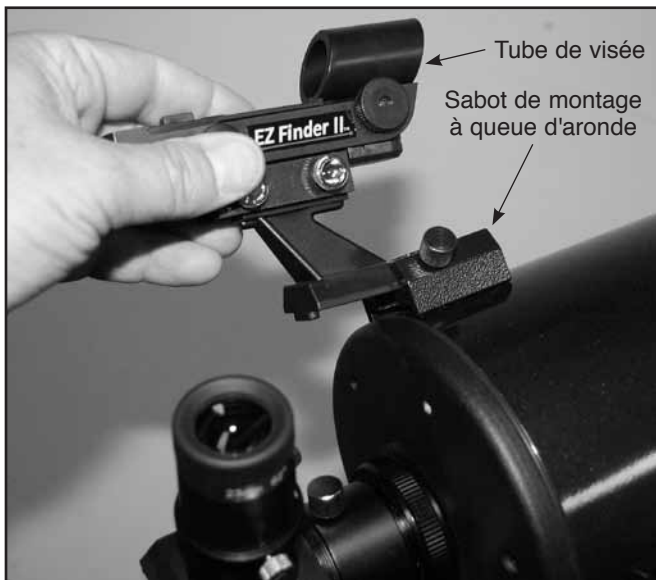
Figure 12. Insérez l'EZ Finder II dans son sabot à queue d'aronde dans le sens indiqué et fixez-le avec la vis.
