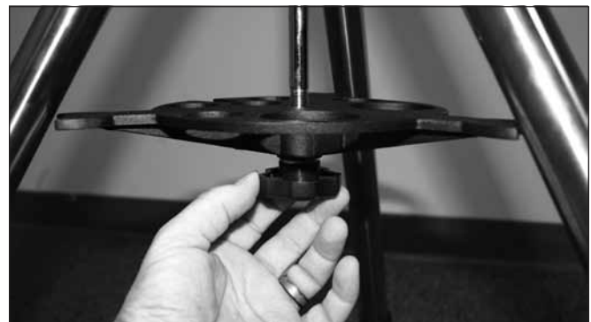
Figure 3. Installez le porte-accessoire / distributeur du trépied avant d'attacher le bras de la monture.
