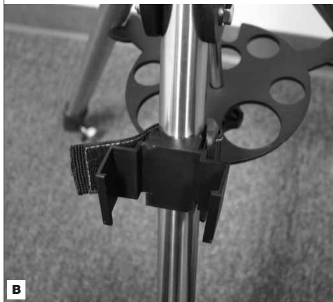
Figure 5. A) Enroulez la sangle autour d'un montant du trépied et tirez fermement avant de serrer. B) Support de la télécommande installé.
