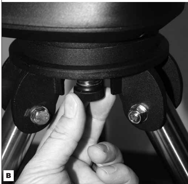
Figure 4. Le bras de la monture s'attache à la plate-forme de montage du trépied à l'aide de trois boulons captifs. A) Alignez les boulons avec les trous au bas de la base du bras. B) Serrez les trois boutons.
