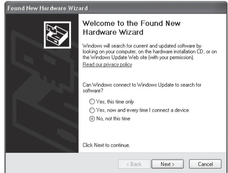
Figure 6. Sous Windows XP, l'assistant d'ajout de nouveau matériel apparaît lorsque vous branchez pour la première fois le SSAG à un port USB.
