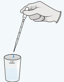
9. Gib die Lösung in einen neuen Becher und stelle sicher, dass nur Flüssigkeit in den neuen Becher gelangt.
